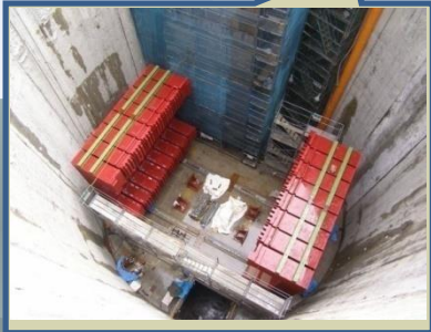
CERNから寄贈されたUA1磁石(1000ton). ニュートリノモニター棟内に設置済み
