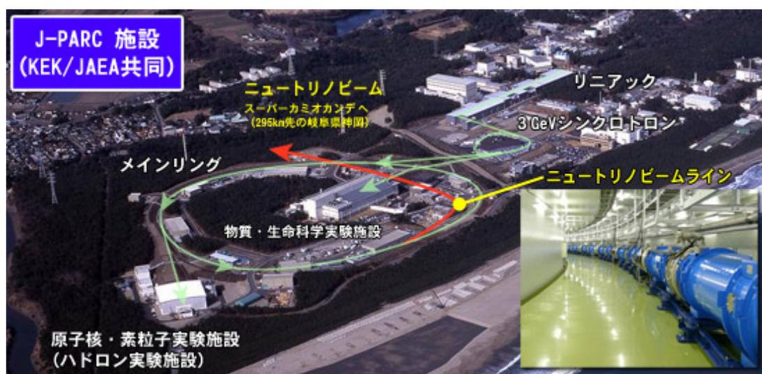
J-PARC では、陽子をリニアックで加速後、3GeV シンクロトロンを経てメインリングに送り込む。陽子をキッカーとよばれる電磁石により内向きに蹴りだし神岡の方向に向けた後、ターゲットに衝突させニュートリノビームに変換、スーパーカミオカンデに向けて発射する。ニュートリノビームは J-PARC 内の前置検出器を用いても観測されているので、スーパーカミオカンデの観測結果と比較することで、ニュートリノが飛行中に別の種類に変わる「ニュートリノ振動」の研究が可能となる。
